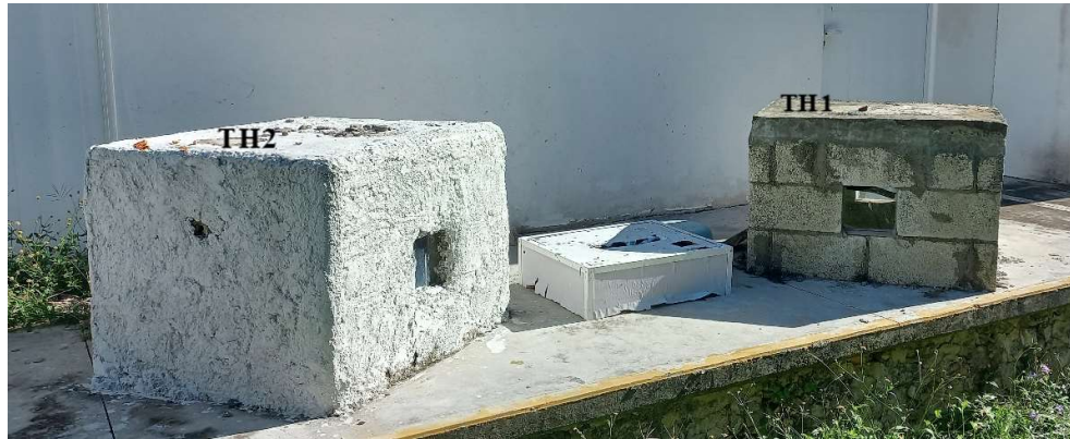
Figura 5: Prototipos utilizados en el estudio comparativo en la etapa 2 (TH1 de referencia, TH2 prototipo modificado).
