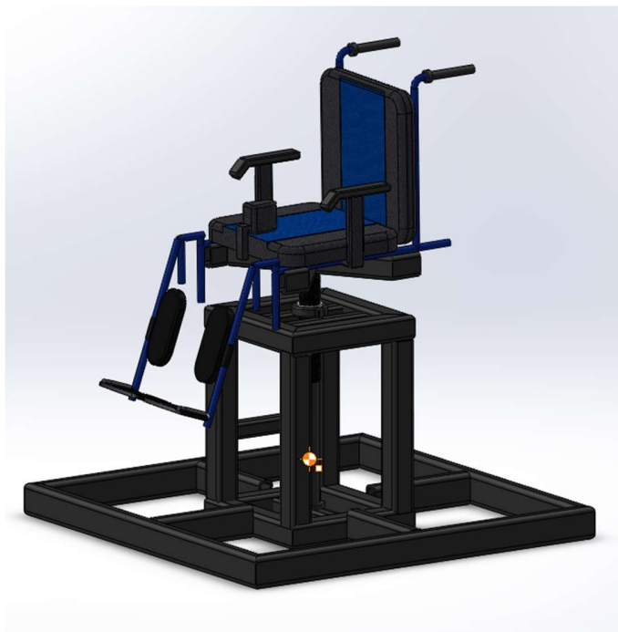
Figura 3 Centro de masa obtenida mediante SolidWorks
