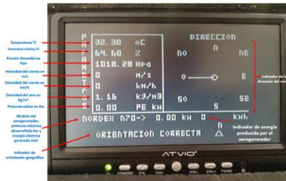
Figura 5. Parámetros eólicos y energéticos de aerogeneradores mostrados en el equipo emulador. Fuente: Elaboración propia (2024).
