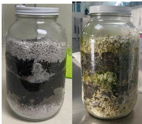
**Figura 3.** Frasco cerrado de manera hermética con la muestra de la bolsa biodegradable Lado izquierdo, inicio de la prueba; Lado derecho a los 4 años de prueba.
