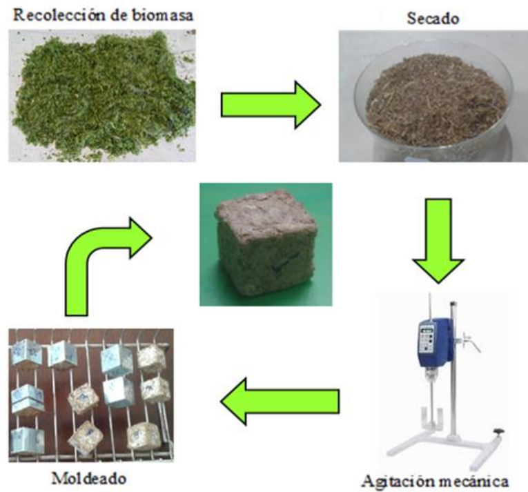
Figura 3. Diagrama de flujo del proceso de obtención de material aislante experimental
